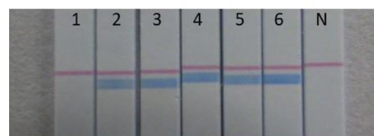
図4：核酸クロマト法による標準型と特異型の識別 1：特異型(道南産)、2：標準型(道南産)、3-4：標準型(中国産)、5-6：標準型(韓国産)、N：陰性コントロール(DNA無)、N：陰性コントロール(DNA無)、矢印：青いラインは検出されたDNAを示す。
