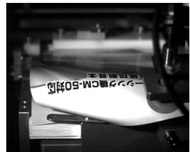
印刷シートの搬送不良[シートの折れ曲がり] (1,000fps)
