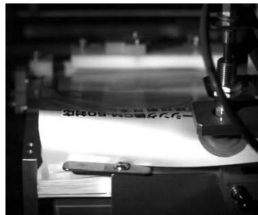
印刷シートの搬送不良[シートの折れ曲がり] (1,000fps)
