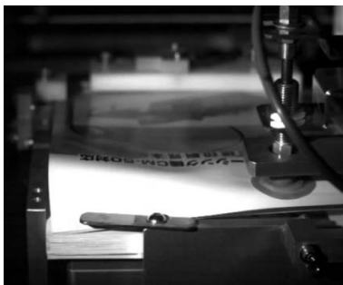
印刷シートの搬送不良[シートの折れ曲がり] (1,000fps)
