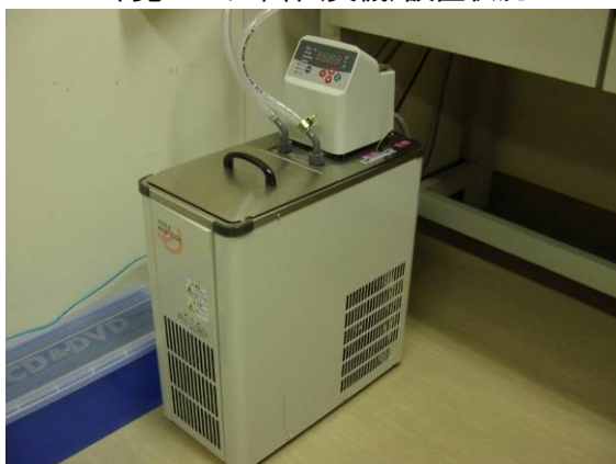
恒温水循環装置設置状況
