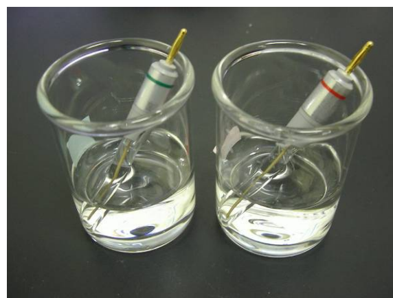
参照電極の浸漬状況
