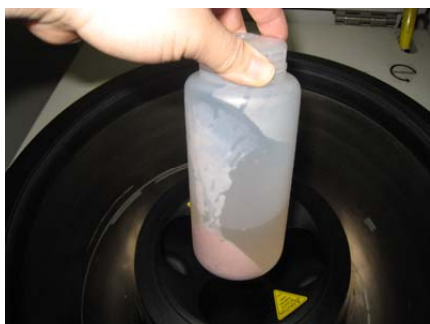
図 3-7 沈殿の凝固を確認
