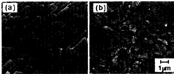
図3 ホタテガイ貝殻の二次電子像 (a)内側表面、(b)外側表面
