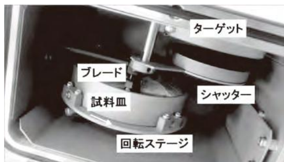
図2 スパッタコーティング用真空チャンバの内部構造
