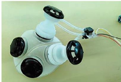
図10 小型流量センサの装着状況
