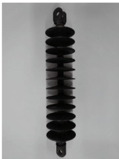
図1 洗浄試験用ポリマーがいしの外観写真
