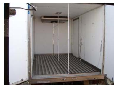
図2 冷凍車内部（熱電対設置後）
