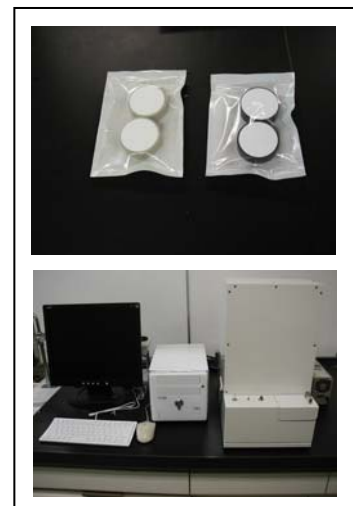
図1 FISHFCシステム 上:簡易検査キット、 下:FISHFC 蛍光計測装置
