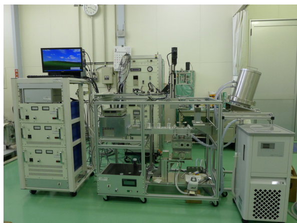
図1 試作した液中蒸発法ナノ粒子製造装置
