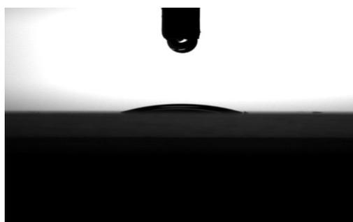
図 3.水の接触角測定結果
