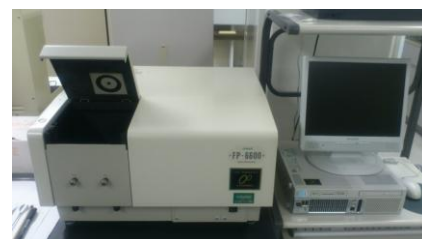
図3 蛍光分光分析装置の外観
