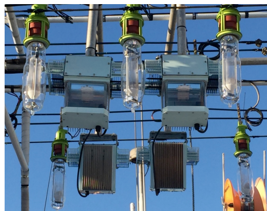
図 3 彰幸丸に艦装されたプラズマ漁灯
