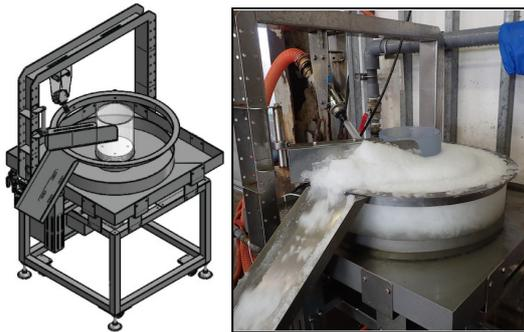
図3 スラリーアイスから脱水氷を製造する装置
