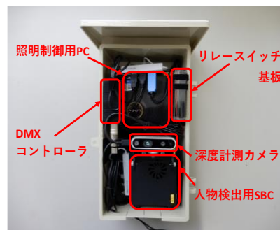
図 3 制御ボックス内部
