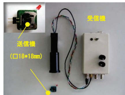
図 3 光通信システム(淡水・海水用)
